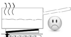
Ferromagnetisches Element wurde schlecht eingebaut
